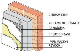
En invierno el sistema SATE impide que el calor escape hacia el exterior y en verano evita el calentamiento de las paredes y de las estancias interiores. De esta forma se ahorran gastos de calefacción durante la época fría y aire acondicionado en los meses de verano. Con un buen aislamiento térmico puede ahorrar hasta un 65% de los gastos energéticos de su edificio o vivienda unifamiliar.
